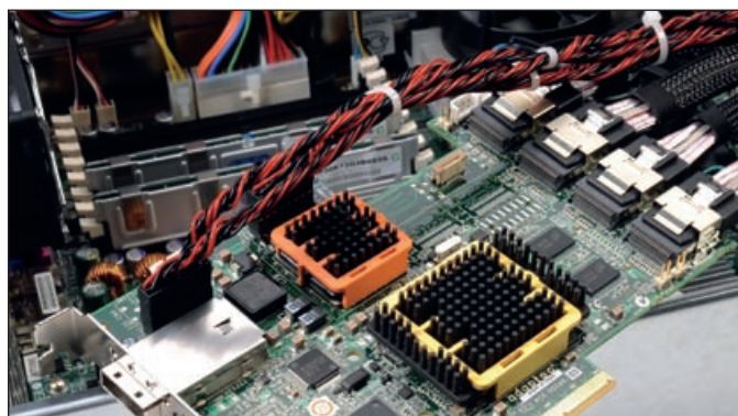
Herzstück: Der Adaptec RAID-51645-Controller unterstützt sowohl SATA- als auch SAS-Platten. Die Anbindung über einen x8 PCI-E-Slot garantiert satte Übertragungsraten.
